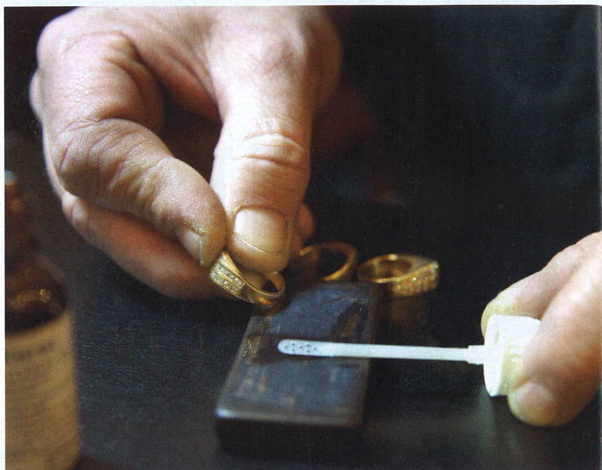
Met een steen en zwavelzuur wordt het goudgehalte vastgesteld.
